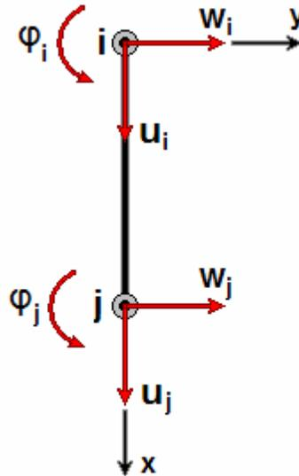
Рис. 9. Балочный конечный элемент с 6-ю степенями свободы
