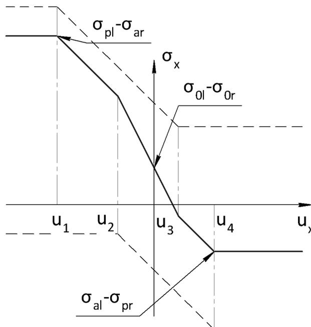
Рис. 7. Зависимость реакции грунта от горизонтального смещения стены
