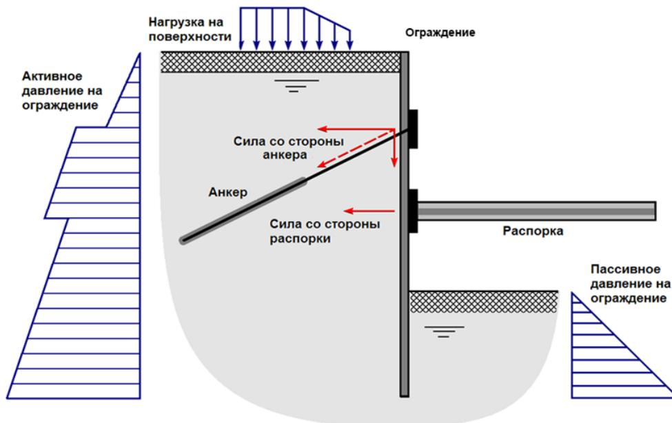
Рис. 1. Расчетная схема
