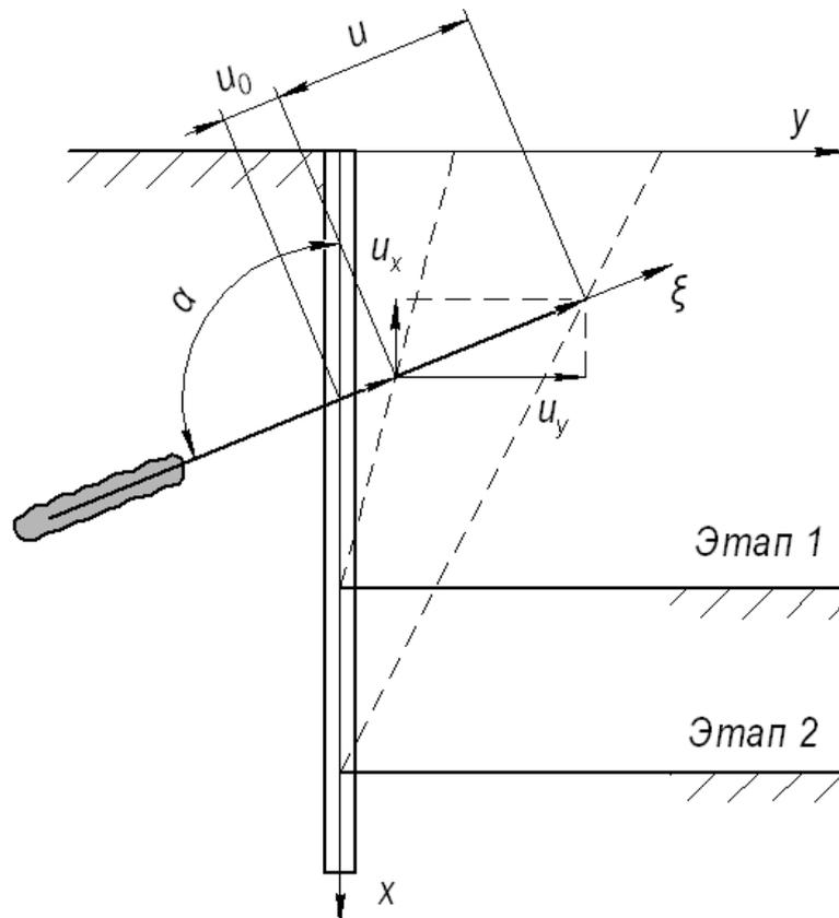
Рис. 8. Расчетная схема определения продольной силы в анкере
